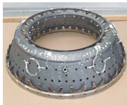
图8 碳化硅陶瓷基复合材料火焰筒
