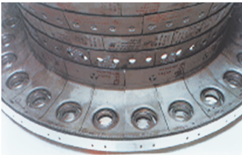
图3 F119发动机燃烧室浮壁式火焰筒
