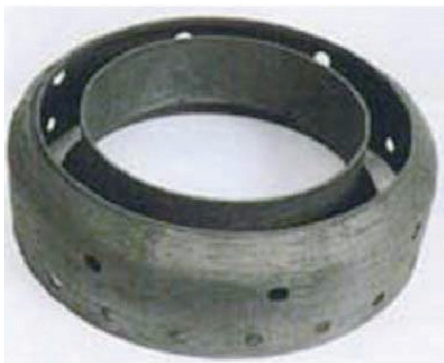
图9 日本研制的CMC火焰筒
